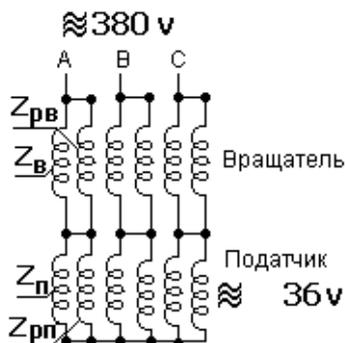
Рисунок 5 – Электрический дифференциал ВПС
