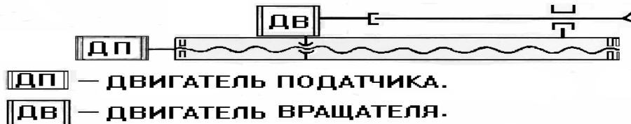
Рисунок 3 – Схема привода ВПМ с автономными приводами вращения и подачи: ДВ – двигатель вращения; ДП – привод подачи
