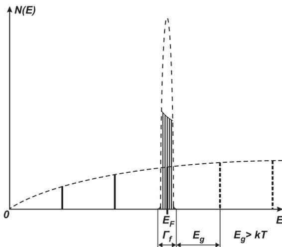
Схема плотности энергетических состояний электронов  $N(E)$  как функции энергии электронов  $E$  в частицах соединений с тяжёлыми фермионами. Незанятые состояния в зоне лёгких электронов выше уровня Ферми  $E_F$  показаны вертикальными штриховыми линиями. Плотность состояний электронов в узкой  $f$ -зоне схематически показана для комнатной температуры.
