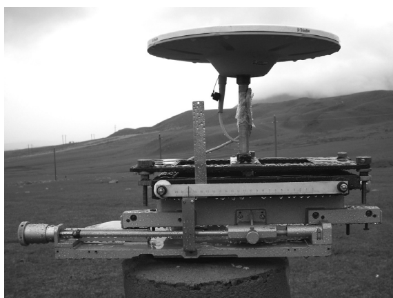
Рис. 1. Вид 3D-корректора с GPS антенной на геодезической тумбе.
