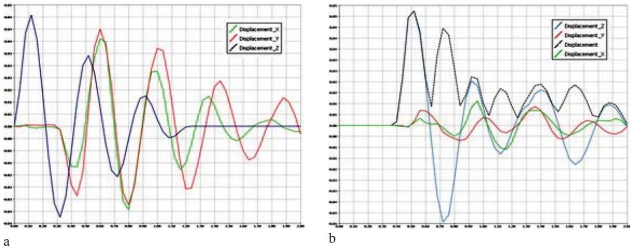
Рис. 3. Графики исходной сейсмической нагрузки (а) на подошву массива и расчетных смещений элемента массива (б) на горизонте 3960-02.
