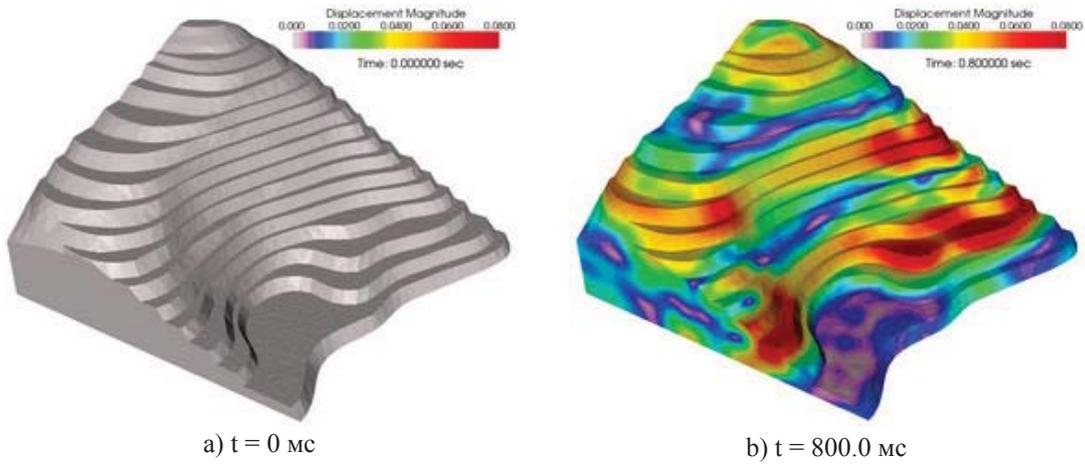
Рис.2. Диаграммы абсолютных смещений под действием сейсмической нагрузки.
