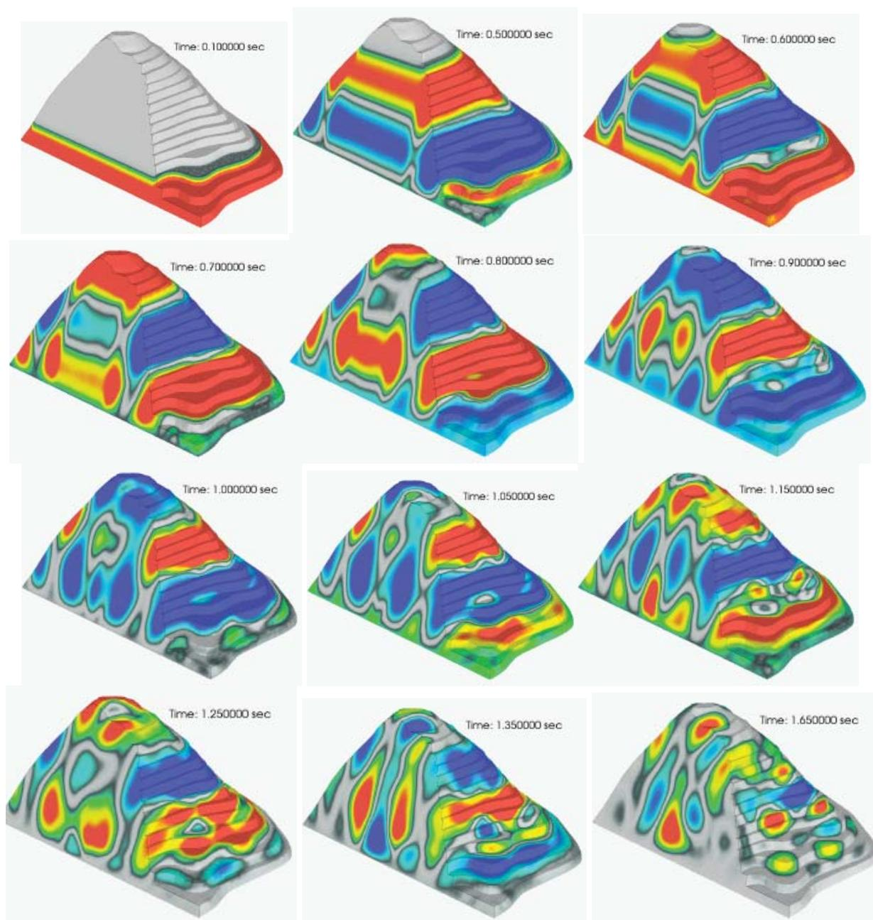
Рис. 5. Распространение сейсмических волн в горном массиве.
