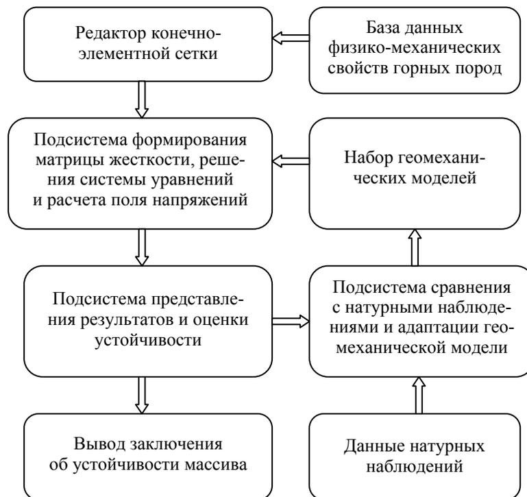
Рис. 1. Структурная схема комплекса Stress.
