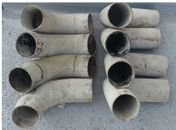
Рисунок 3 – Экспериментальный стенд из труб, извлеченный из водовода Ассинского ПМК после 1 года эксплуатации
