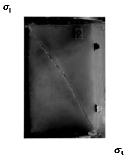
Рисунок 1 – Плоскость среза для мрамора при \sigma_1 = 275 МПа, \sigma_2 = 107 МПа, \sigma_3 = 25 МПа
