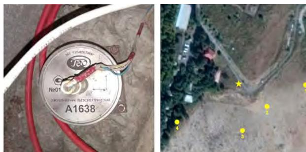
Рисунок 1 – Геоакустический приемник А1638 (а), карта расположения серий имитационных событий: звездочкой обозначено расположение геофона (б), кружками – пункты проведения имитаций сигналов
