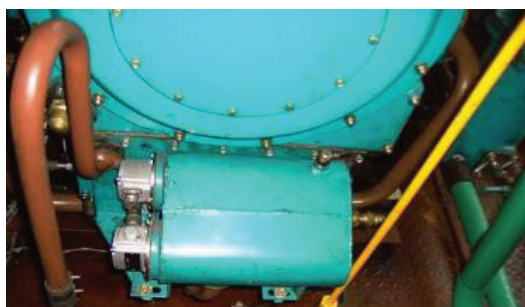
Рисунок 5 – Мерная емкость уровня масла в поддоне с дистанционными датчиками уровня масла
